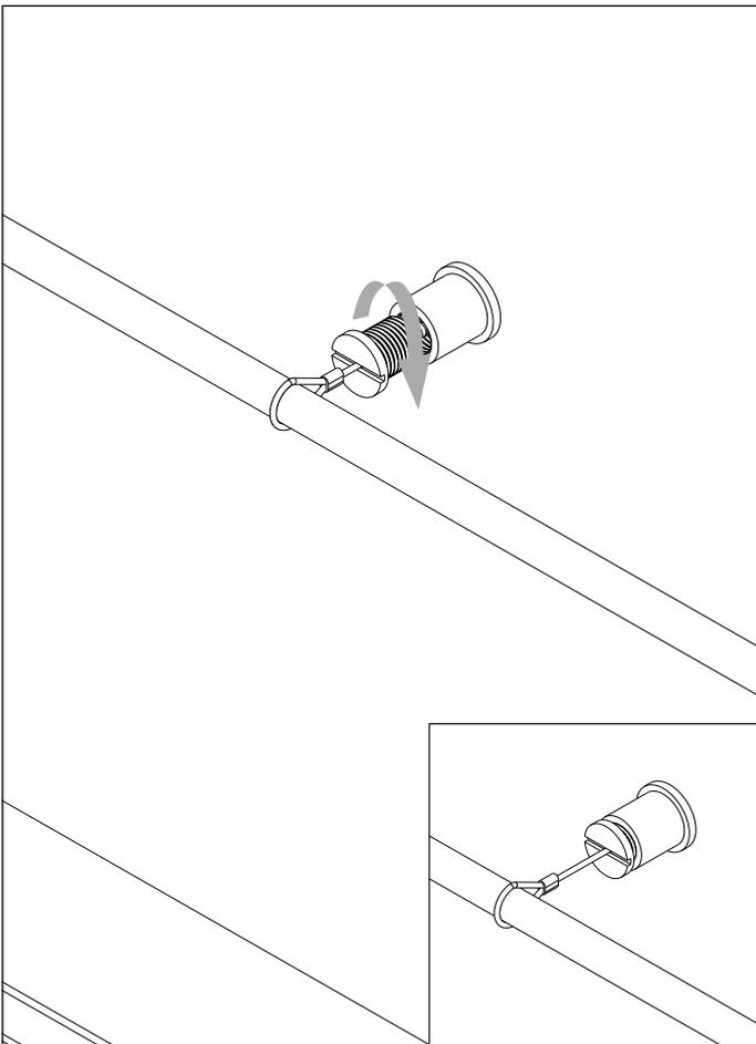
**8.** Serrer la seconde partie de l'attache dans celle fixée au mur. Ne pas utiliser d'outil pour serrer, uniquement les doigts afin de ne pas serrer trop fort.
