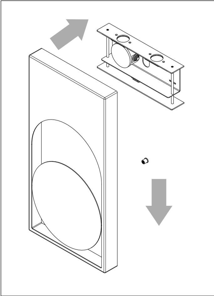
**7.** Mettre en place la coque en la plaçant tout d'abord contre le mur, légèrement au-dessus du boîtier électrique, et ensuite l'amener vers le bas pour la poser sur le boîtier.
