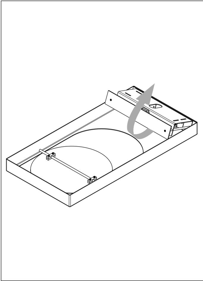
**1.** Retirer le boîtier électrique en effectuant un mouvement de rotation pour le détacher des aimants.
