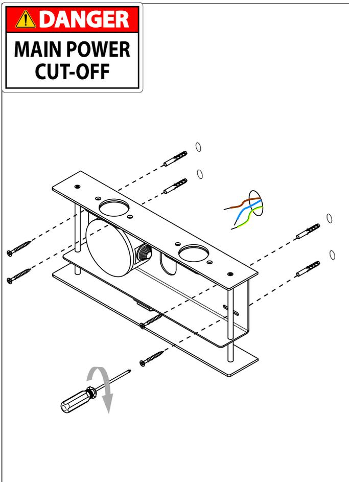
**2.** Fixer le boîtier électrique au mur au moyen de fixations adaptées au support (non fournies).
