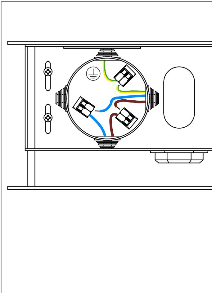
**4.** Effectuer les connexions électriques à l'intérieur du boîtier étanche. Replacer ensuite soigneusement le couvercle.
