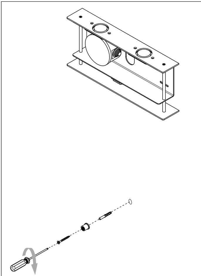
**6.** Fixer l'attache au mur au moyen d'une fixation adaptée au support (non fournie).
