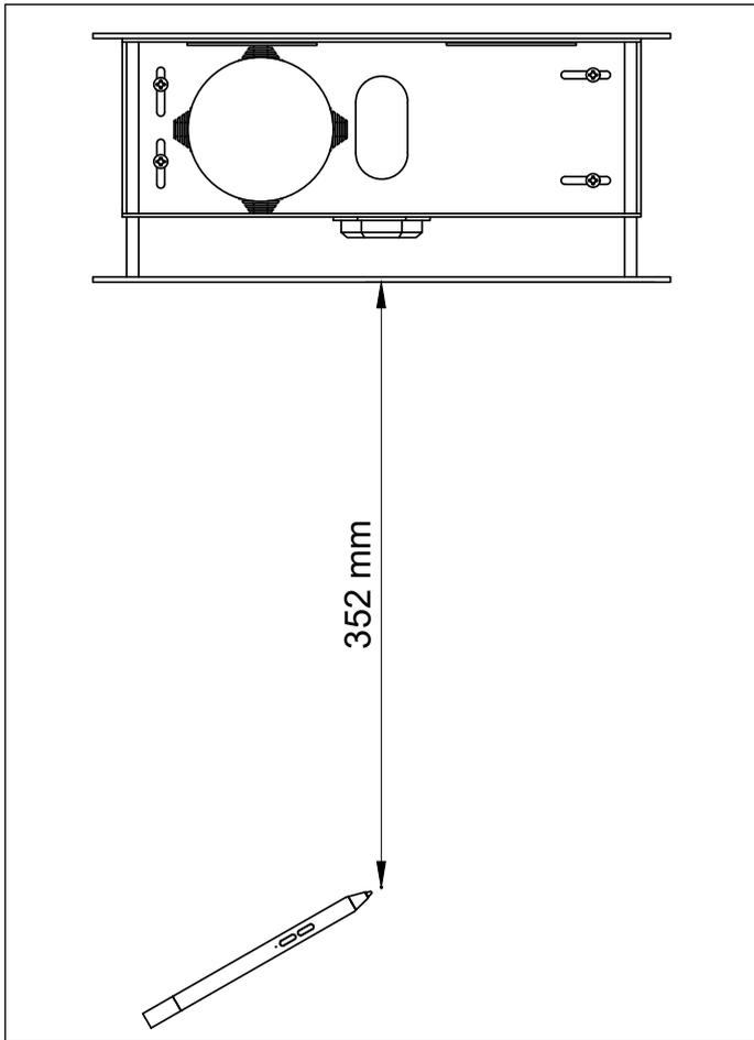
**5.** Mesurer 352mm sous le diffuseur de lumière dans l'axe du boîtier. Percer ensuite un trou à cet endroit pour fixer l'attache de sécurité.
