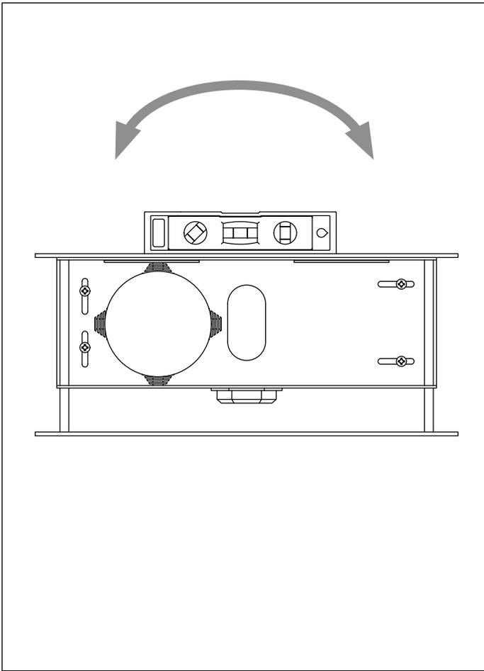
**3.** Ajuster correctement le boîtier au moyen d'un niveau à bulle.
